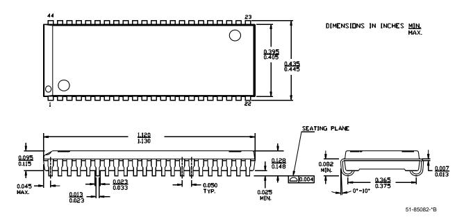
Figure 12. 44-Pin TSOP II (51-85087)
